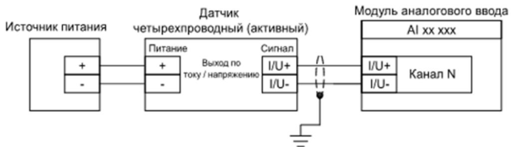
Рисунок Б.3.3 - Четырехпроводная схема подключения датчика (активного) к модулям аналогового ввода
