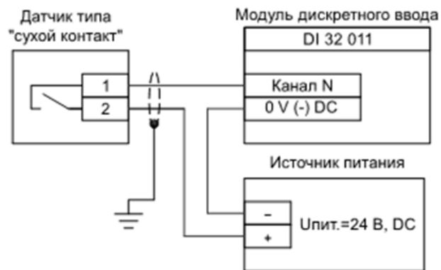
Рисунок Б.1.1 - Двухпроводная схема подключения датчика типа "сухой контакт" к модулям дискретного ввода
