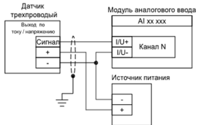
Рисунок Б.3.2 - Трехпроводная схема подключения датчика к модулям аналогового ввода
