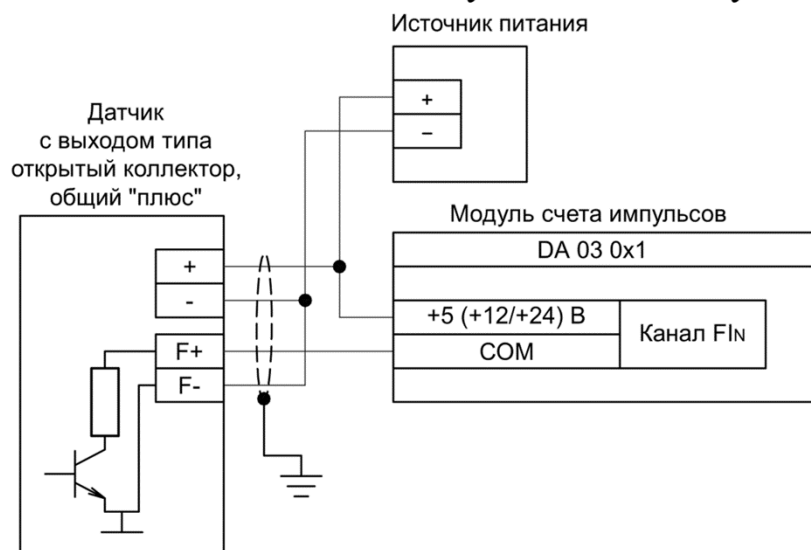
Рисунок Б.5.1 - Схема подключения датчиков с выходом типа открытый коллектор, общий "плюс" к модулям счета импульсов
