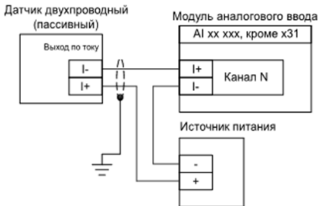
Рисунок Б.3.1 - Двухпроводная схема подключения датчика к модулям аналогового ввода
