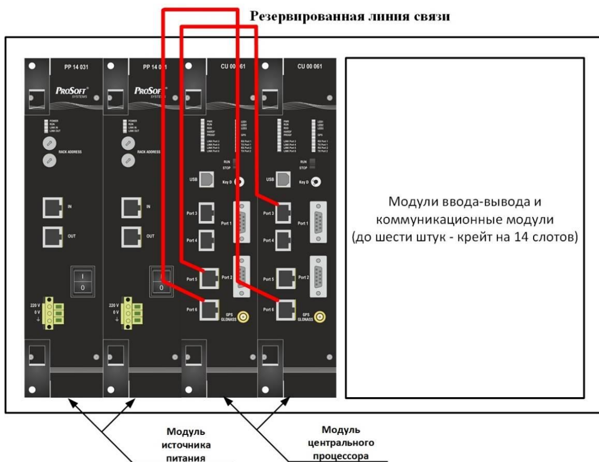
Рисунок 9 – Базовый крейт в резервированном варианте
