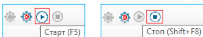
Рисунок 9 – Кнопки Старт / Стоп в среде разработки прикладного программного обеспечения Astra.IDE
