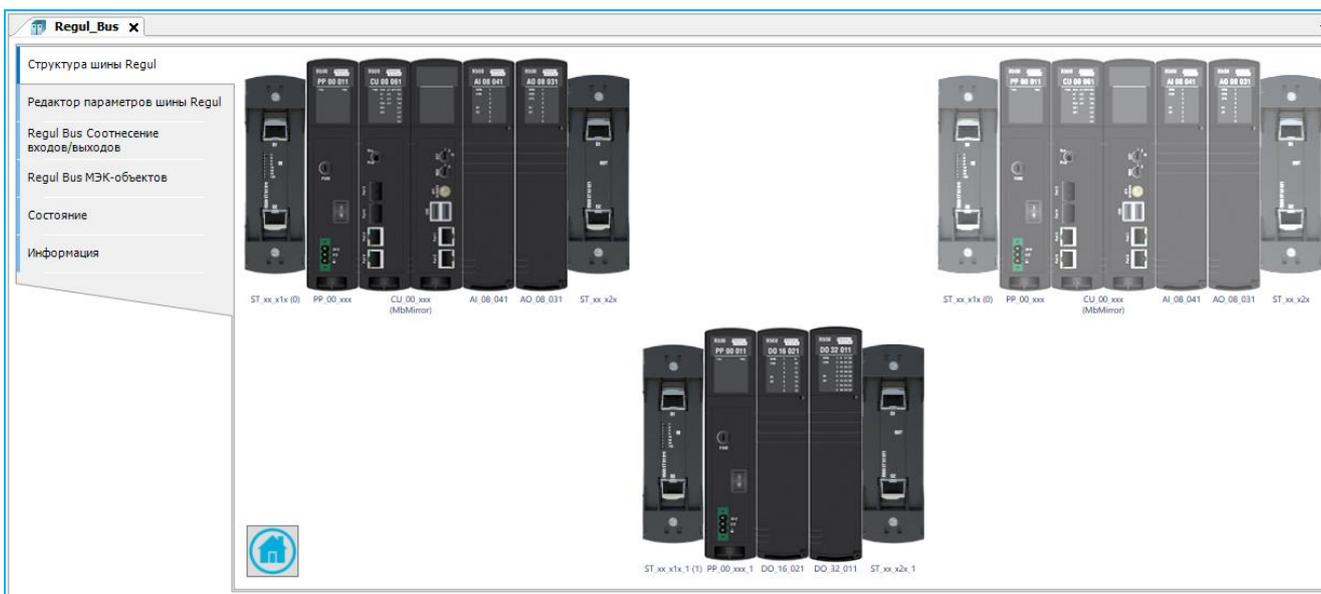
Рисунок 28– Редактор шины контроллера R500 (полное + частичное резервирование)
