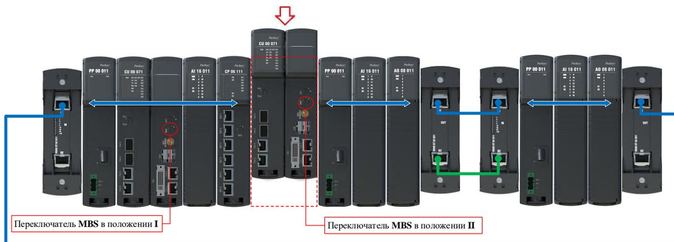
Рисунок 2 – Пример организации подключения по схеме «кольцо»
